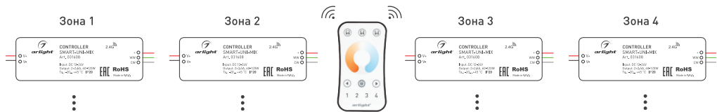
Рисунок 3. Вариант построения системы с 4-зонным пультом дистанционного управления
